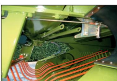
**LEGATORE A DUE SPAGHI:** Una programmazione elettronica dal controller consente di scegliere tutti i parametri di legatura, adattandoli ad ogni tipo di prodotto.
