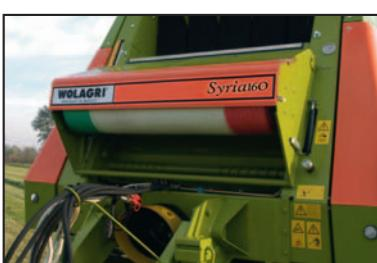
**LEGATORE A RETE:** L'introduzione della rete avviene in maniera forzata, garantendone il funzionamento anche nelle condizioni più difficili. I numeri di avvolgimenti vengono programmati automaticamente dal controller in funzione del diametro impostato.
