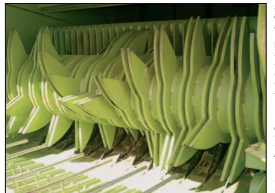
Sistema di taglio con 14 coltelli protetti singolarmente contro corpi estranei, che possono essere esclusi-inseriti idraulicamente dal posto di guida. Il loro smontaggio-montaggio avviene con una semplice manovra. E' possibile lavorare anche con un numero variabile di coltelli.
