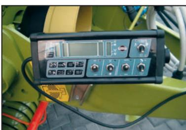
**CONTROLLER:** L'operatore può eseguire tutte le funzioni dal posto di guida, avendo sotto controllo lo svolgimento di tutte le operazioni fino alle segnalazioni audio-visive di inizio-fine legatura ed espulsione balia. Il sistema è stato progettato per poter essere utilizzato anche in stato di "emergenza", funzionando anche escludendo l'elettronica.
